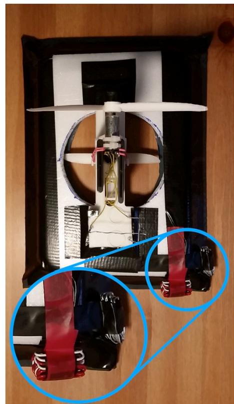
**Abbildung 39:** Position der Balancemassen für zweidimensionale Bewegungen.
