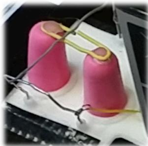
Schaumstoff-Ohrstöpsel werden als Zeitverzögerungsschalter verwendet. Eine zurechtgebogene Büroklammer dient als Brücke zwischen den beiden Ohrstöpsel und wird mit Heißkleber auf denen befestigt. Durch Zusammendrücken der Ohrstöpsel kann eine Zeitverzögerung erreicht werden, da der Kontakt der Drahtbügel erst durch die ausgedehnten Ohrstöpsel wieder hergestellt wird.
