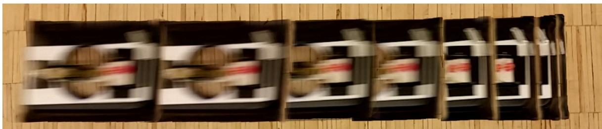
Abbildung 40: Darstellung einer eindimensionalen, gleichförmig beschleunigten Bewegung.
