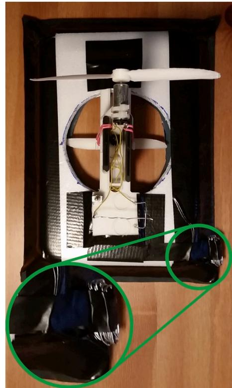
Abbildung 41: Position der Balancemassen für eindimensionale Bewegungen.
