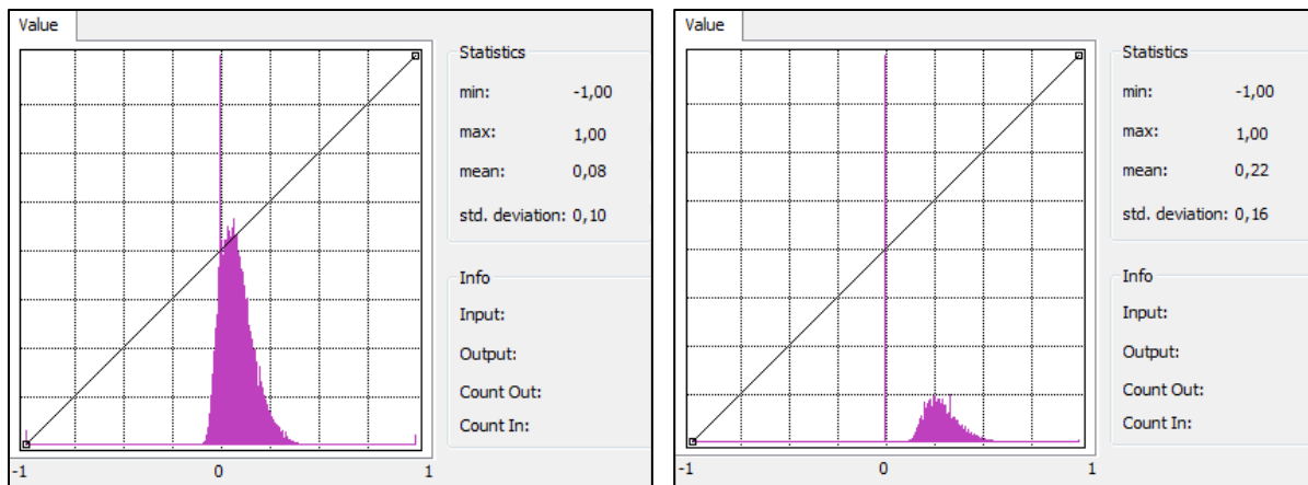
Abb. 15: Histogrammvergleich des NDVI für die Szenen vom 13. Juli 2004; links das unbearbeitete Bild, rechts kalibriert auf TOARF (eigene Darstellung)
