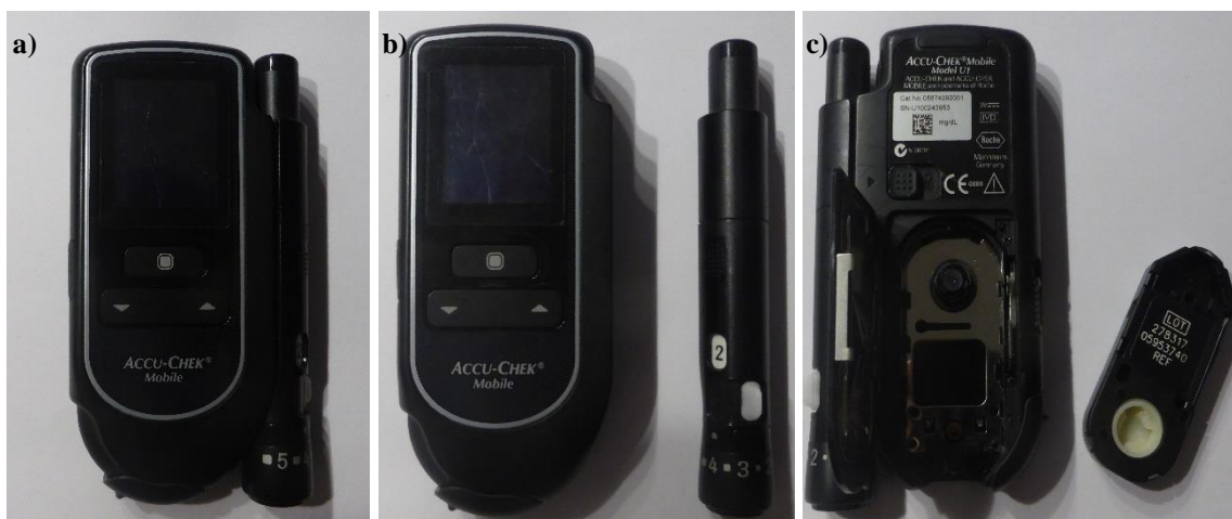
Abb. 95a-c: Reflexionsphotometrisch arbeitende Blutzuckermessgeräte; a Accu-Chek Mobile, b mit abgenommener Stechhilfe, c umgedreht mit herausgenommener Trommel/Kassette
