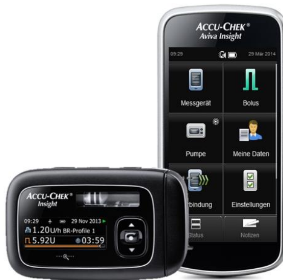
Abb. 79: Accu-Chek Insight Insulinpumpe (mit sichtbaren Reservoir links und Accu-Chek Aviva Insight Diabetes Manager rechts) [222]
