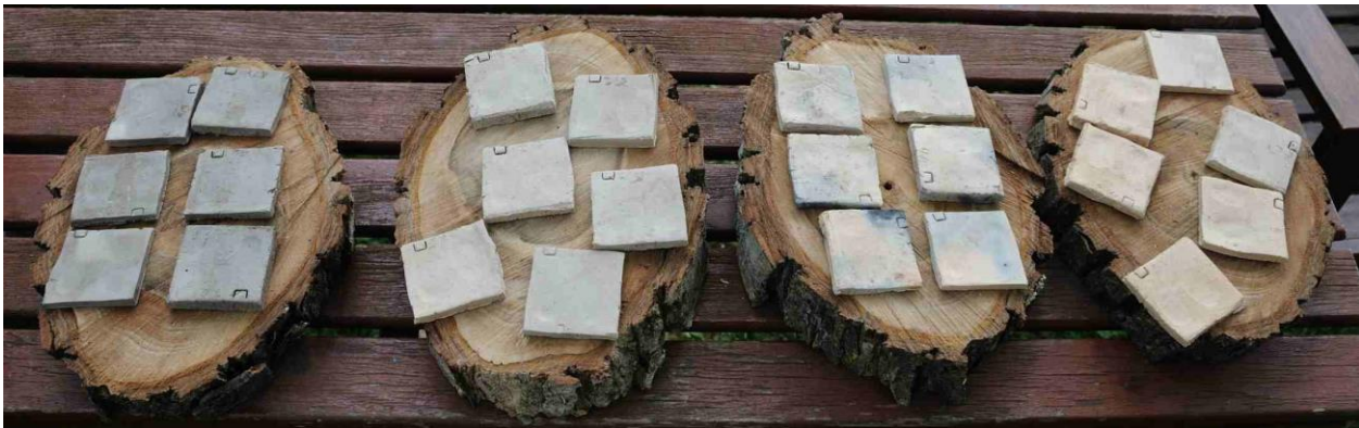
Abbildung 20: Tontafel nach dem Brand. Unterschiedliche Brenntemperaturen sind aus den unterschiedlichen Farbschattierungen ersichtlich. Von links nach rechts: Brand im Ofen T = 480^{\circ}\text{C} - 520^{\circ}\text{C} , Brand im Ofen T = 600^{\circ}\text{C} - 650^{\circ}\text{C} , offener Brand T = 730^{\circ}\text{C} , Brand im Ofen T = 900^{\circ}\text{C}
