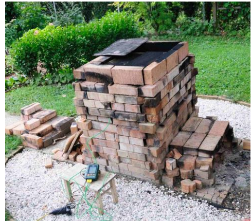
Abbildung 18: Geschlossener Ofen mit zwei Schürkanälen u.r.
