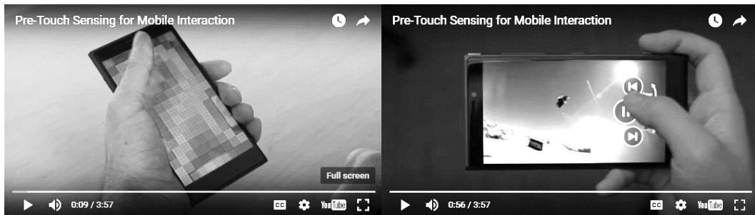
Abb. 28: Video-Demonstration der „Pre-Touch Sensing“ Technologie. Im linken Bild wurden die äußeren Berührungspunkte und die sich annähernden Finger aus Gerätesicht zu Demonstrationszwecken visualisiert. Das rechte Bild zeigt ein Kontextmenü, das mit dem Finger erscheint und verschwindet, wenn sich dieser entfernt. Bildquelle: Microsoft Research, „Pre-Touch Sensing for Mobile Interaction“, 09.12.2016, URL: https://www.youtube.com/watch?time_continue=56&v=fiZkEYLXctE [17.04.2017].
