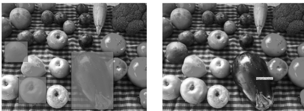
Abb. 41: Links eine Visualisierung einer Image-Map, wie sie für die Benutzer_innen jedoch nicht sichtbar ist. Rechts ist ein Textfeld zu sehen mit dem Inhalt „Melanzani-Rezepte“, welches sichtbar wird, sobald sich die Maus über die Melanzani bewegt. Bildquelle: Eigene Bearbeitung / Screenshots, basierend auf der vorigen Abbildung (Public Domain).
