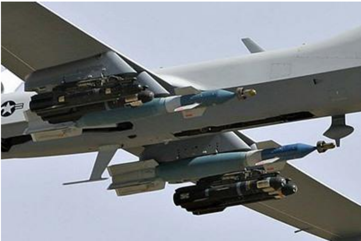
Abb. 8: Standardwaffenzuladung einer bewaffneten amerikanischen UCAV vom Typ MQ-9A Reaper der US-Airforce bestehend aus zwei lasergelenkten 500 Pfund (230 kg) Präzisionsbomben vom Typ GBU-12 Paveway II und vier Luft-Boden-Raketen vom Typ AGM-114 Hellfire. Statt der beiden GBU-12 können auch entweder zwei 500 Pfund GBU-38 Joint Direct Attack Munition (JDAM) Präzisionsbomben oder weitere zehn AGM-114 Hellfire zugeladen werden. Mit letzterer Zuladung wäre die Drohne praktisch in der Lage, auf einer Mission vierzehn individuelle Ziele anzugreifen zu können.
