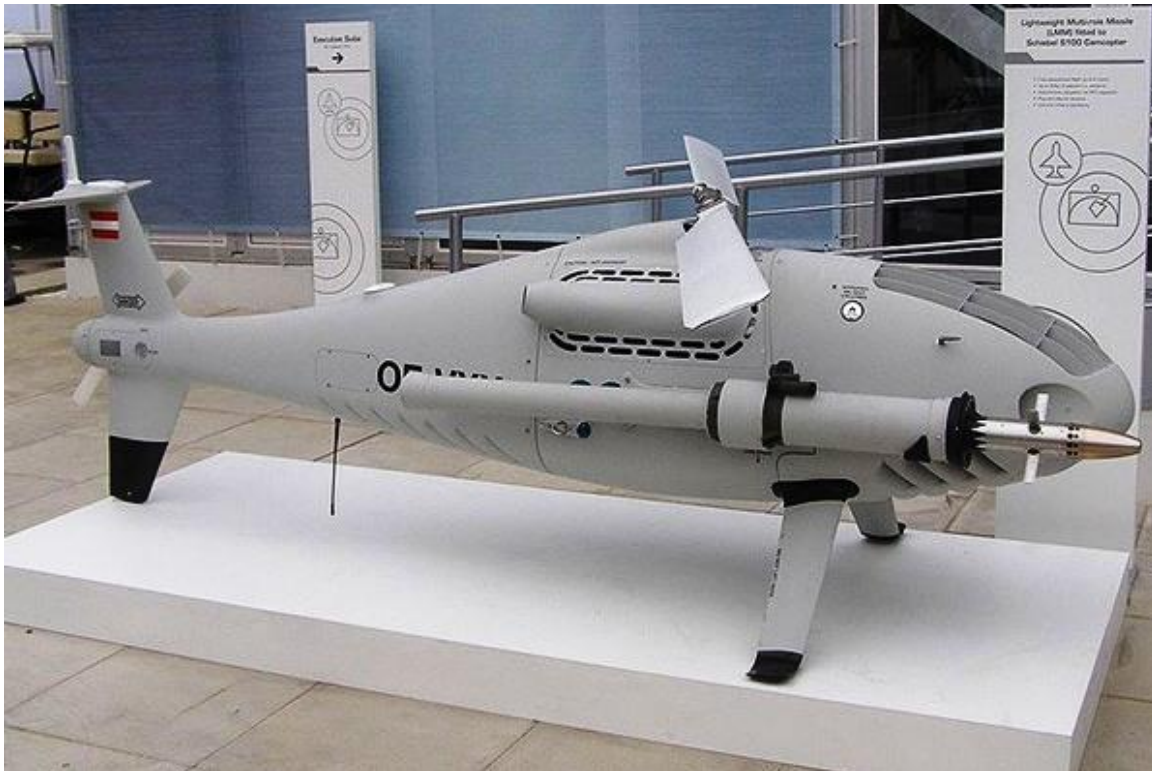
Abb. 2: Eine mit britischen Luft-Boden-Raketen vom Typ Lightweighth Multirole Missile (LMM) bewaffnetes UCAV vom Typ S-100 Camcopter der österreichischen Firma Schiebel auf der Farnborough Airshow im Jahr 2008. Im Februar 2014 schloss die Firma Schiebel einen Vertrag mit dem italienischen Verteidigungsministerium ab. Ziel ist es dabei, die italienische Marine mit S-100 Systemen für den Einsatz gegen Anti-Piraterie-Missionen auszustatten. Größter Nutzer des S-100 sind die Streitkräfte der Vereinigten Arabischen Emiraten mit über einhundert (mit Masse in Lizenz produzierten) Stück.
