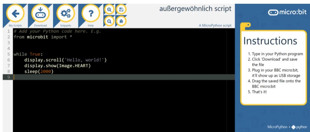
Abbildung 4: BBC micro:bit - Programmieren mit Python
