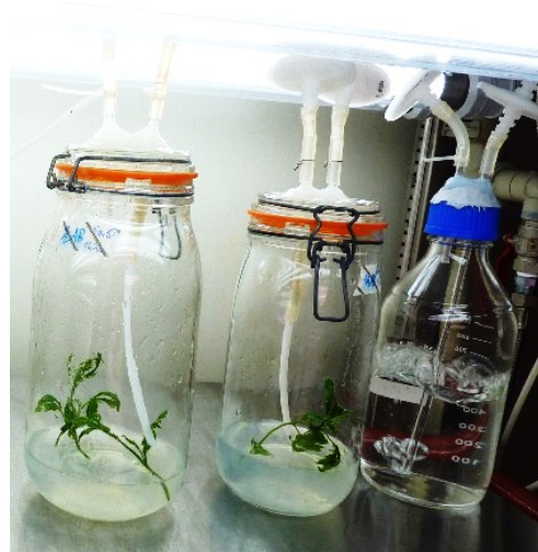
Abb. 6 Zwangsbelüftete Weck Gläser mit vorgeschaltetem Luftbefeuchter
