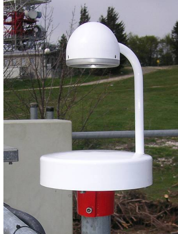
Abbildung 4.1: Feldmühle am Gaisberg zur Messung der elektrischen Feldstärke.
