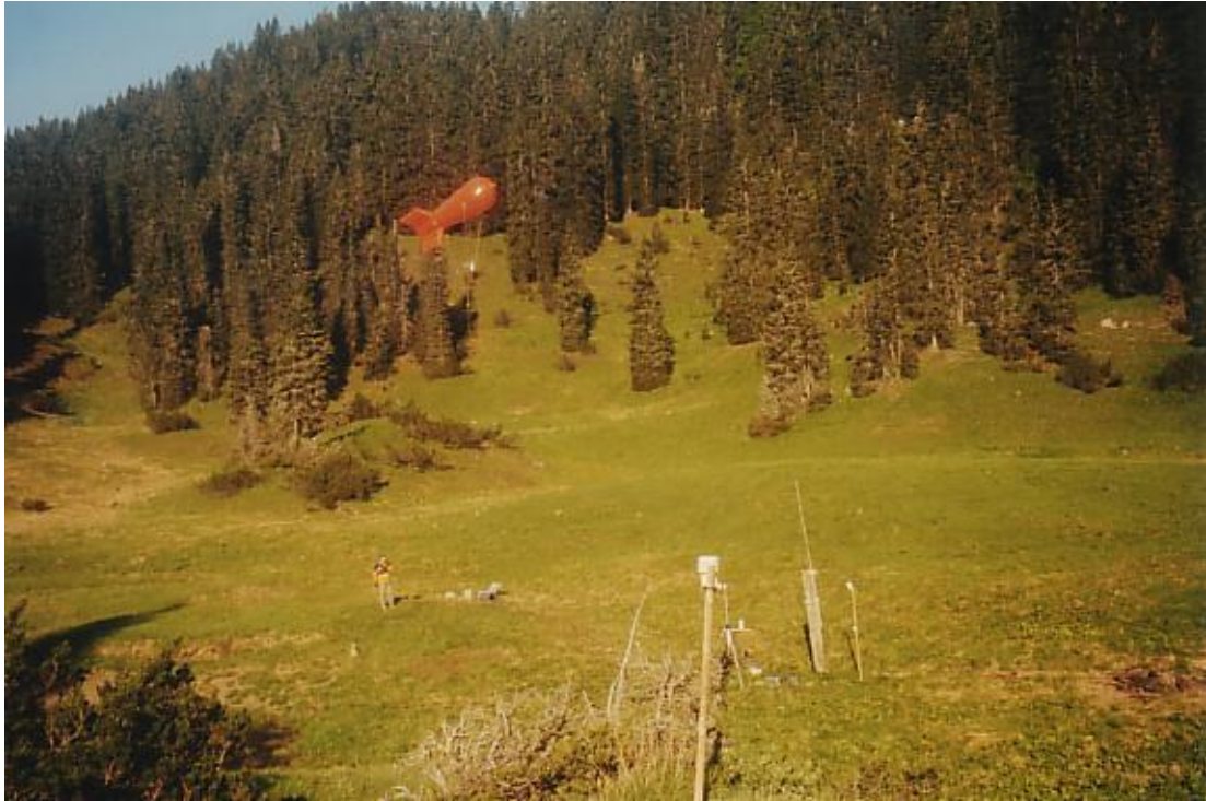
Abb. 11 Tethersonde TS 1 am Morgen des 4. Juni 2002. Im Vordergrund ist der Temperatursensor SE01 zu erkennen.
