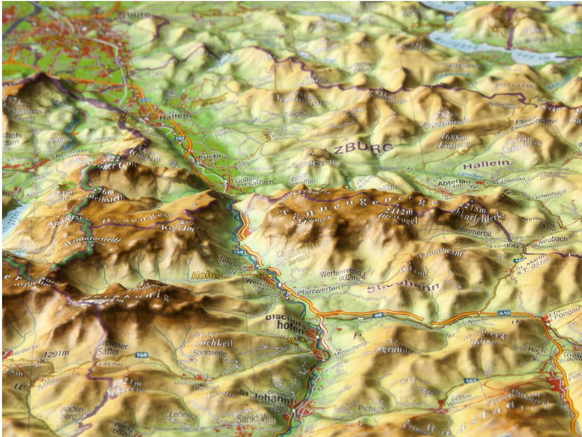
Abbildung 8: Reliefkarte nach Witt: Kunststofffolie, auf die eine Karte aufgedruckt ist und mittels Vakuum geformt wurde, Salzammergut im Maßstab: 1:300.000, 385 x 290 x 15 cm, Überhöhungsfaktor: 1,4 [ger-18]
