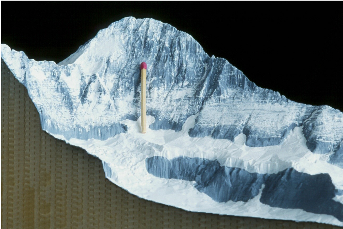
Abbildung 79: Sichtbare Querstrukturen im Felsen als Artefakte der additiven Fertigung (Zündholz als Größenvergleich); ©Mika Semann
