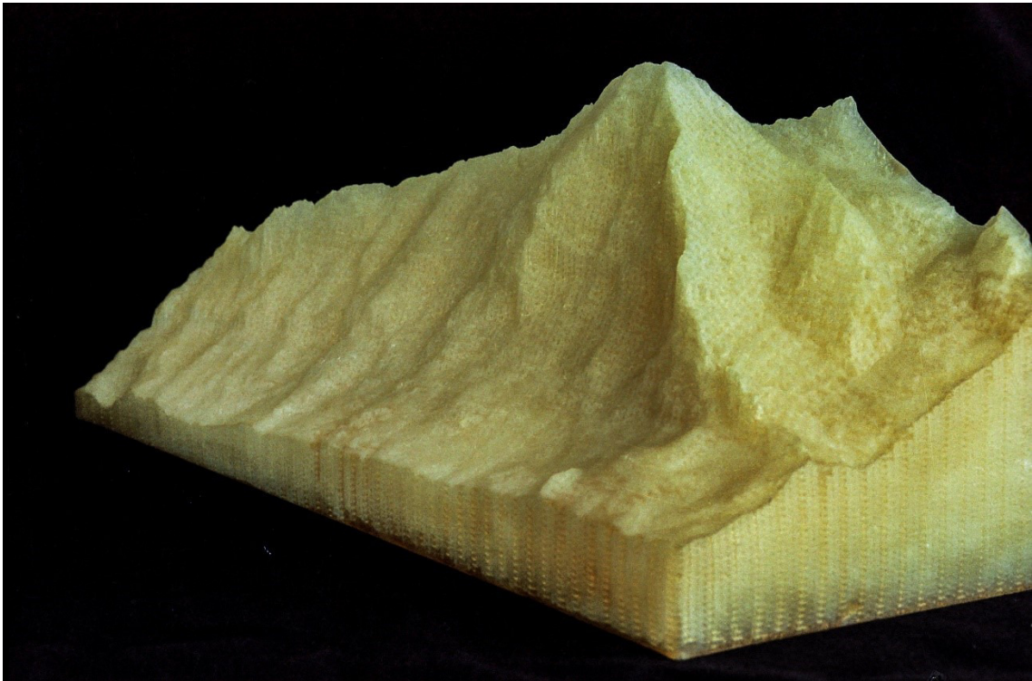
Abbildung 51: Eiger Relief - Stereolithographie, unlackiert; ©Mika Semann
