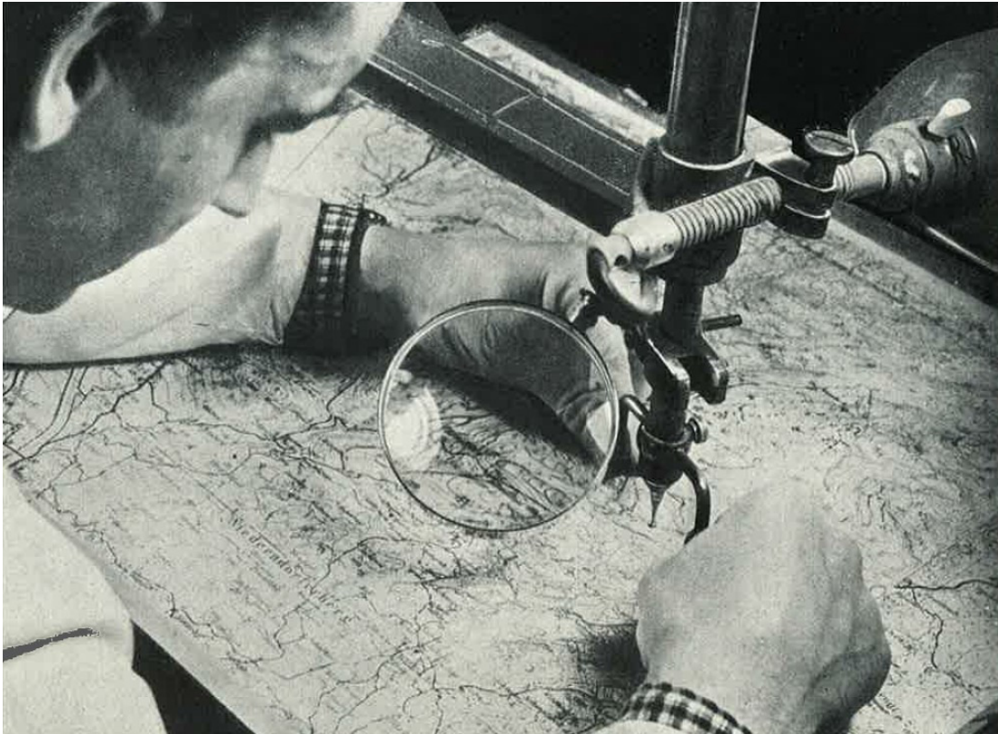
Abbildung 46: Wenschow-Verfahren - Abfahren der Höhenlinien mit Hilfe einer Lupe [KNE-52: 11]
