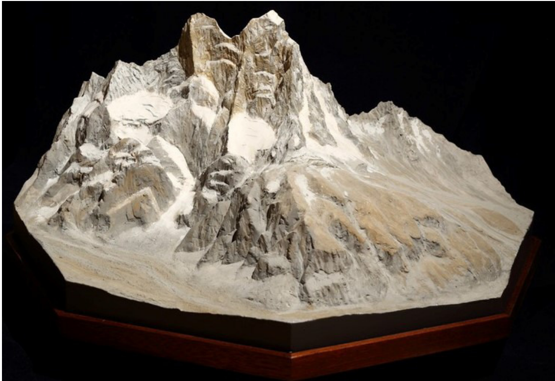
Abbildung 5: Relief mit Oberflächenbedeckung und naturähnlich bemalt (=topographische Reliefs) des Shivling (6.543 m Höhe) im Garhwal Himal in Indien im Maßstab 1:10.000, 50 x 50 cm, Achteck [pus-18a]
