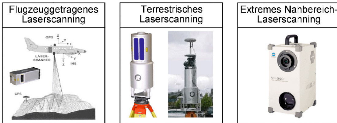
Abbildung 31: Laserscanning Verfahren [KRA-04: 450, 486]
