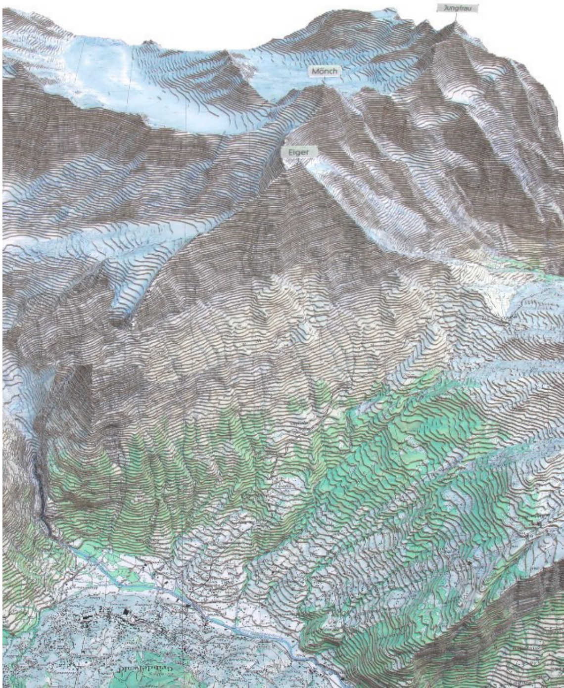
Abbildung 7: Kartenrelief mit aufgedruckter Karte. Ausschnitt des Eiger, Mönch und Jungfraureliefs von Ernst Schefer, Maßstab 1:15.000, Masse: 86 x 96 cm, Äquidistanz 20 m [ern-18]
