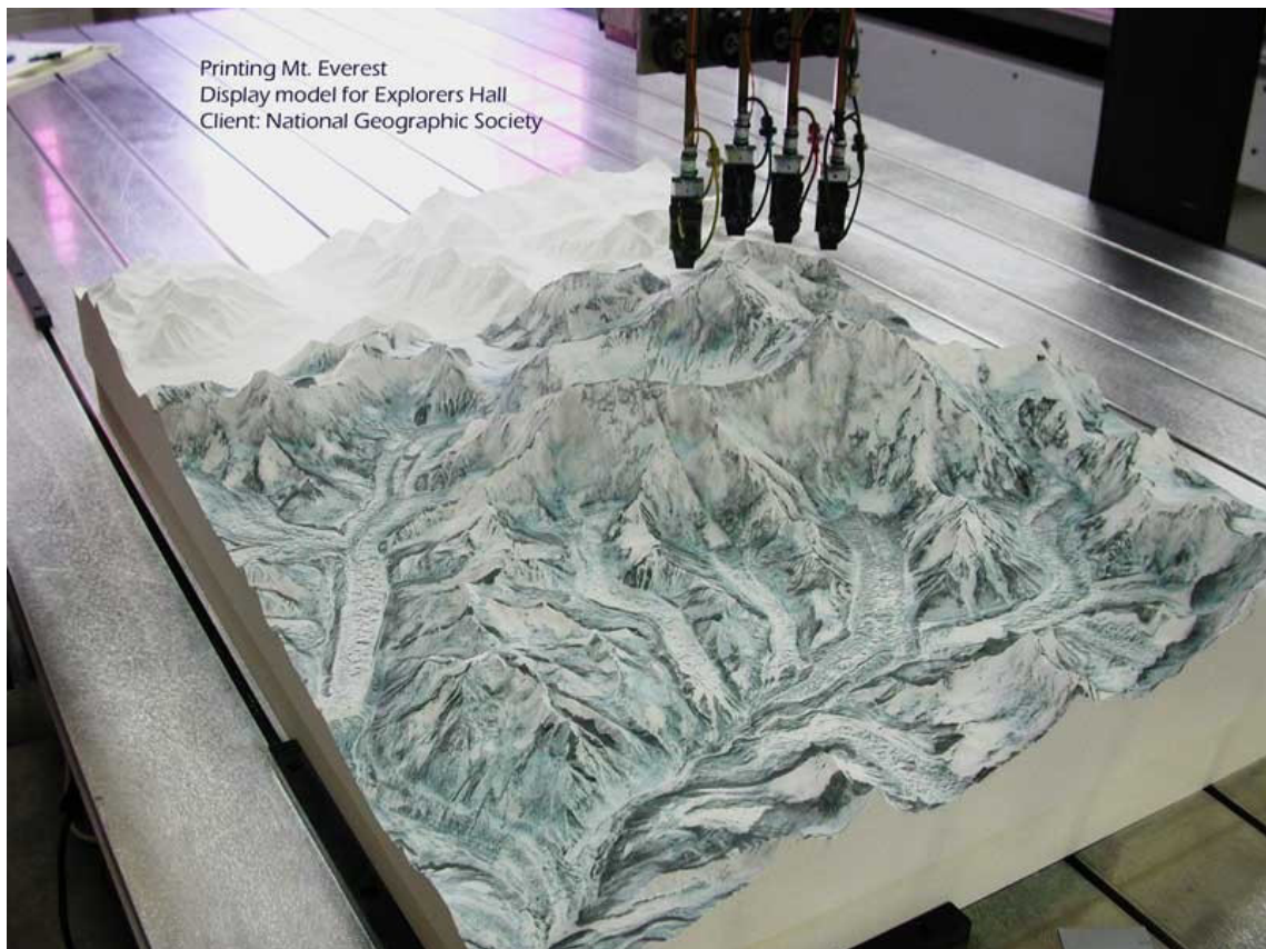
Abbildung 61: CNC gefrästes Modell vom Mt. Everest der Firma Solid Terrain Modeling während dem Farbauftrag mittels Tintenstrahldüsen [stm-13b]
