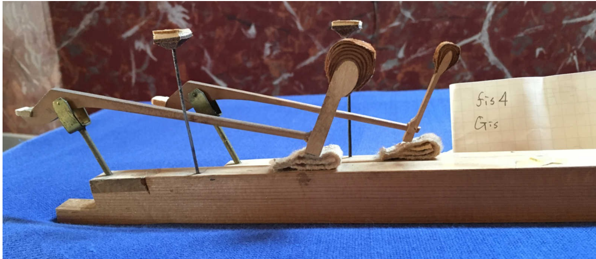
Abbildung 8: Hämmer des Rosenberger-Flügels (Foto: Taniguchi)
