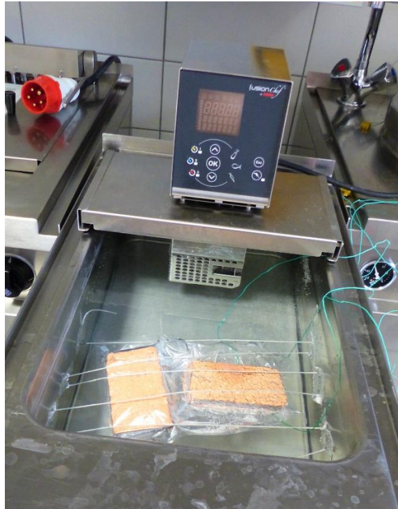
Abbildung 10 – Fusion-chef im Wasserbad. Schnurkonstruktion, um die Steine in ihrer Position und unter Wasser zu halten.
