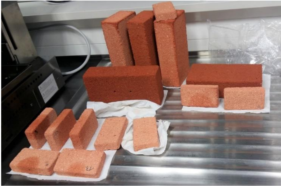
Abbildung 4 - unterschiedliche Größen der Testlebensmittel Steine. Die großen Steine haben eine Dicke von 6,4 cm, die kleinen Steine eine Dicke von 2,5 cm.
