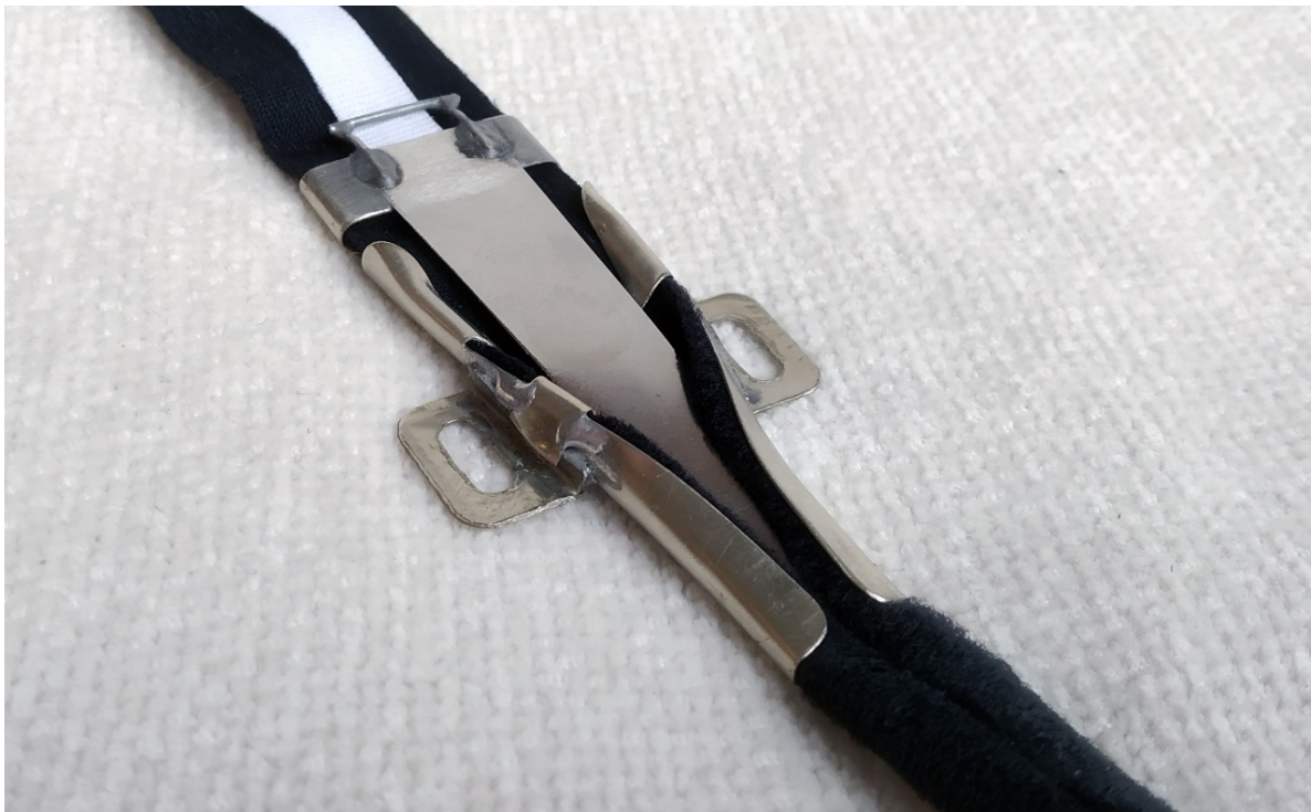
Abbildung 29: Bandfalter zum Einschlagen eines Stoffbandes mit Gummieinzug.
