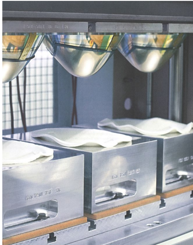
Abbildung 26: Molding-Pressen zur Herstellung von nahtlosen BH-Cups. 230
