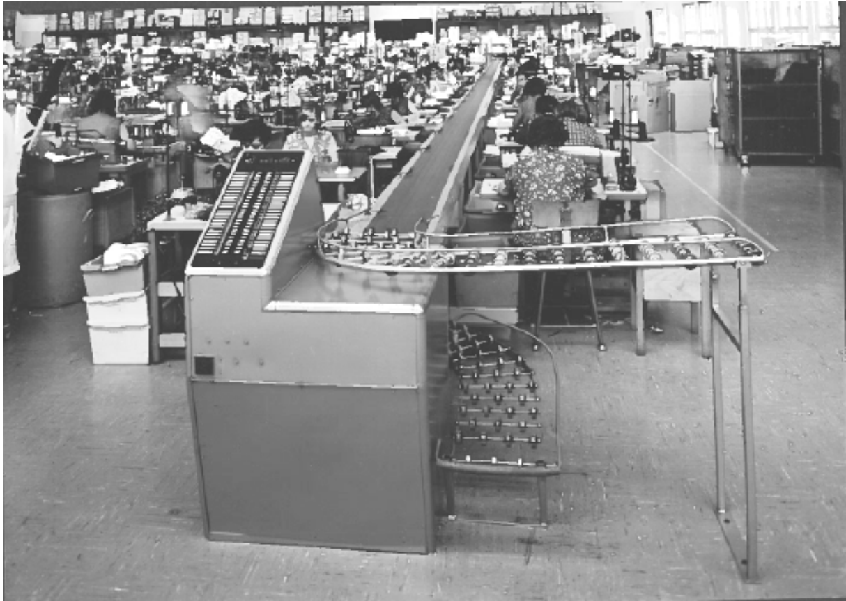
Abbildung 25: Erste "Cunliffe" Förderanlage aus dem Jahr 1968
