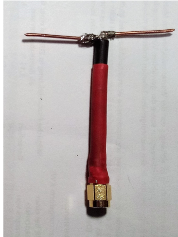
(a) Dipol der ersten Eigenbau-Generation.
