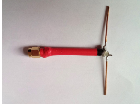
Abbildung 4: Links: Schematische Abbildung eines Dipols (vgl. Tabelle 1), rechts: Bild eines selbstgebauten Dipols (eigenes Foto).
