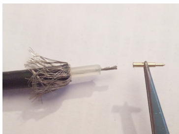
(a) Abisoliertes Koaxialkabel und Spitze des SMA-Anschlusses.
