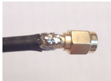
(b) SMA-Anschluss mit angelöteter Abschirmung.
