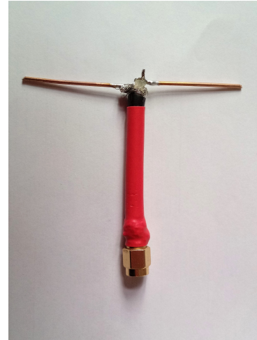
(b) Dipol der dritten Eigenbau-Generation.
