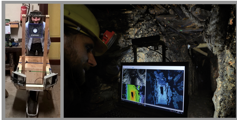
Abbildung 38: Links: Das fertige mobile 3D-Messgefährt mit der oben montierten SLAM-Kamera. Rechts: Erste Testreihen im Christian-von-Tusch-Werk (Quelle: Links: T. Ragger 2017, NHM Wien. Rechts: D. Brandner 2017, NHM Wien, Interreg Projekt VirtualArch Hallstatt.)
