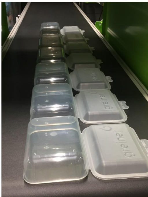
Abbildung 19: Das fertige Produkt: Jausenboxen, die mit gebrauchtem Granulat hergestellt wurden; ©Verena Reichl
