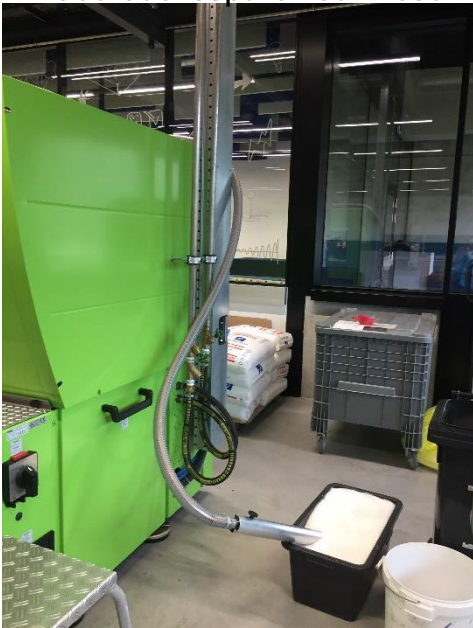
Abbildung 17: Vernetzung des gebrauchten Granulats (siehe schwarze Kiste) mit einer Maschine; ©Verena Reichl
