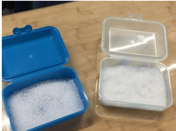
Abbildung 18: In der blauen Dose befindet sich neues Granulat, in der transparenten Dose gebrauchtes Granulat, das wiederverwertet wird, ©Verena Reichl
