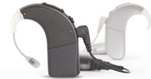
Abbildung 10: Audioprozessor von AB mit innovativem Mikrofon nahe am Gehöreingang (Offizielle Website von Advanced Bionics, Letzter Zugriff: 01.06.2020).
