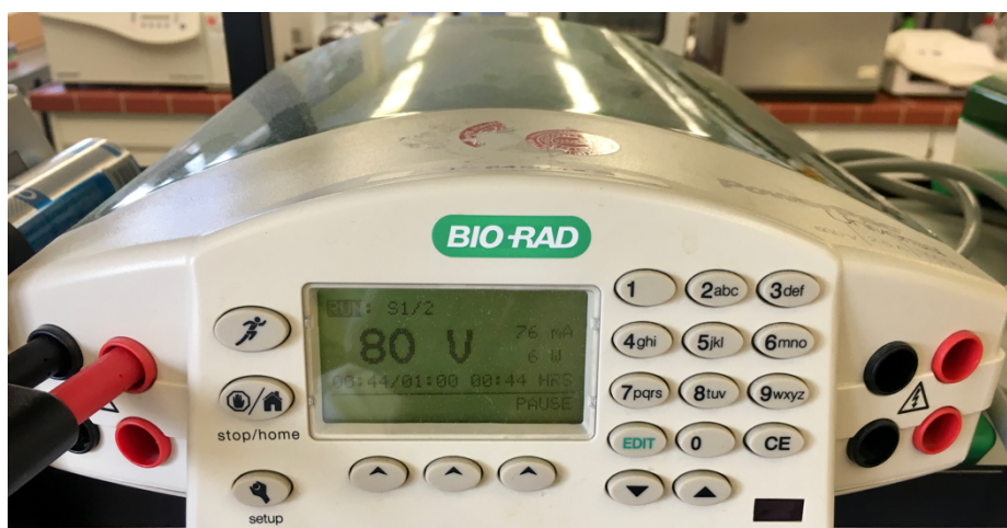
Abbildung 19: Gerät zur Einstellung der Spannung für die Agarose-Gelelektrophorese
