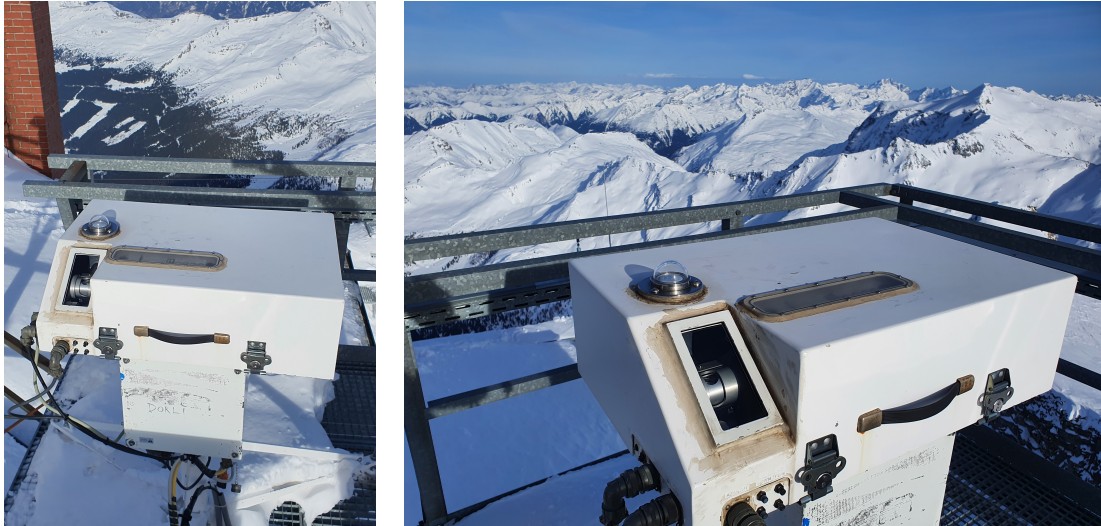
Abbildung 3.2: Das #93 Brewer MkIV Spektrophotometer am Hohen Sonnblick. Man sieht die Quarzglaskuppel mit dem Messeingang für spektrale UV-Messungen und die 45° geneigte Quarzglasscheibe mit dem Messeingang für Direktmessungen, Zenitmessungen und Umkehrmessungen. Fotos von Matthias Daxbacher, ZAMG.
