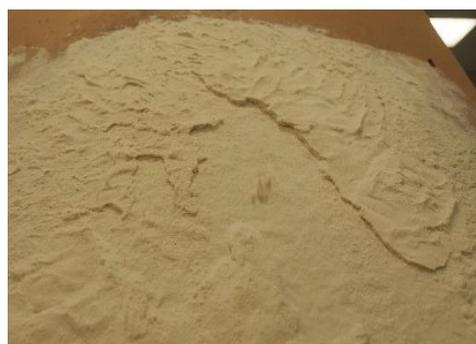
**Abbildung 9:** Initialbruch in der Schwachschicht (eigene Darstellung)
