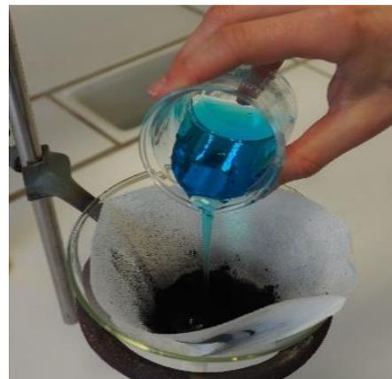
**Abbildung 5:** Wasseraufbereitung durch Aktivkohle (eigene Darstellung)
