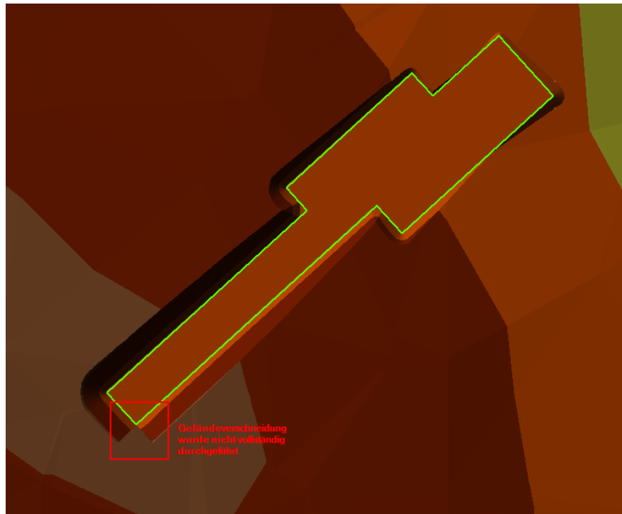
Abb. 44: Mögliche Fehler bei der Geländeverschnidung aufgrund von nicht geschlossenen Linien
