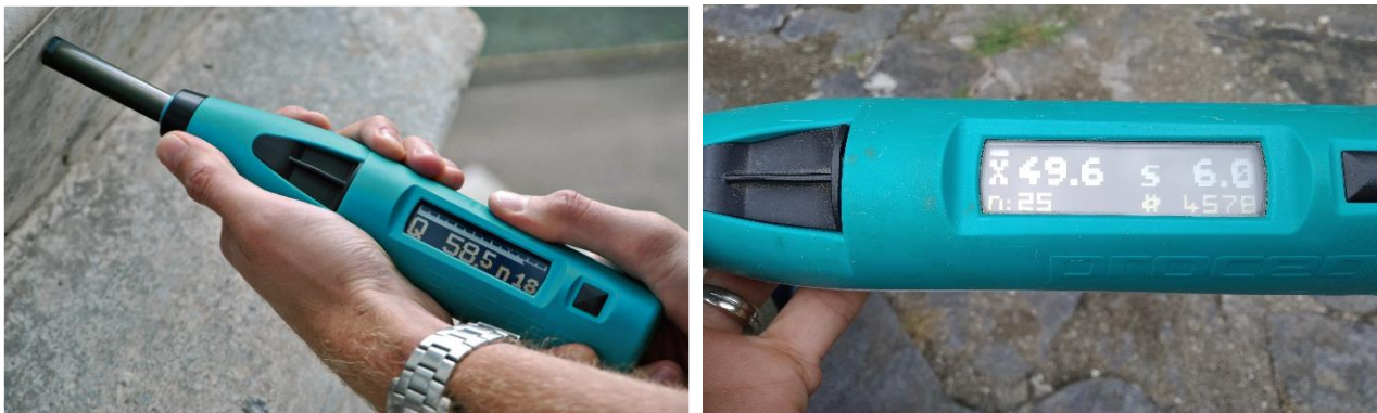
Abbildung 58 Rückprallhammer Silver-Schmidt-Type-L von Proceq (links nach (Proceq 2016) und rechts wurde bei der Feldarbeit fotografiert (August 17, 2019).
