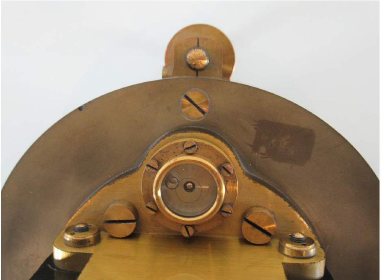
Abbildung 9.2: Spiegelgalvanometer Nr.300117 - Libelle auf der Hartgummischeibe an der Rückseite des Gerätes
