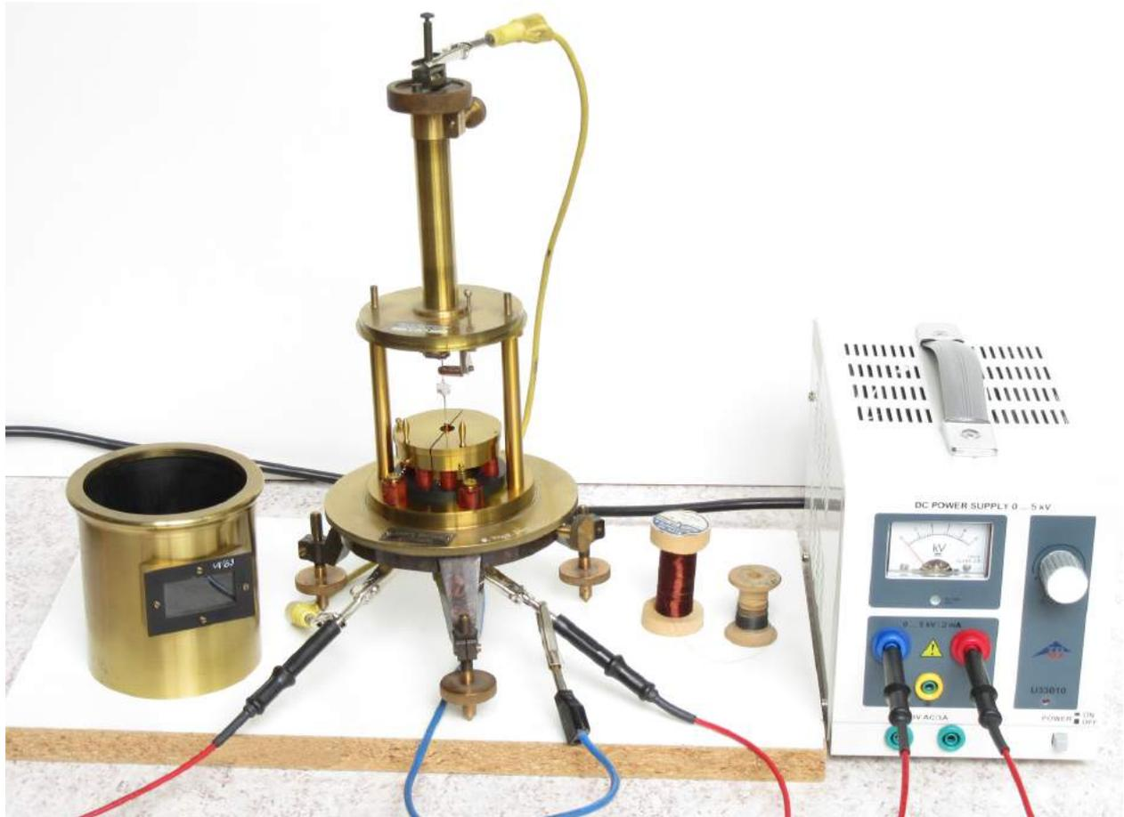
Abbildung 4.6: Binantenelektrometer - Versuchsaufbau
