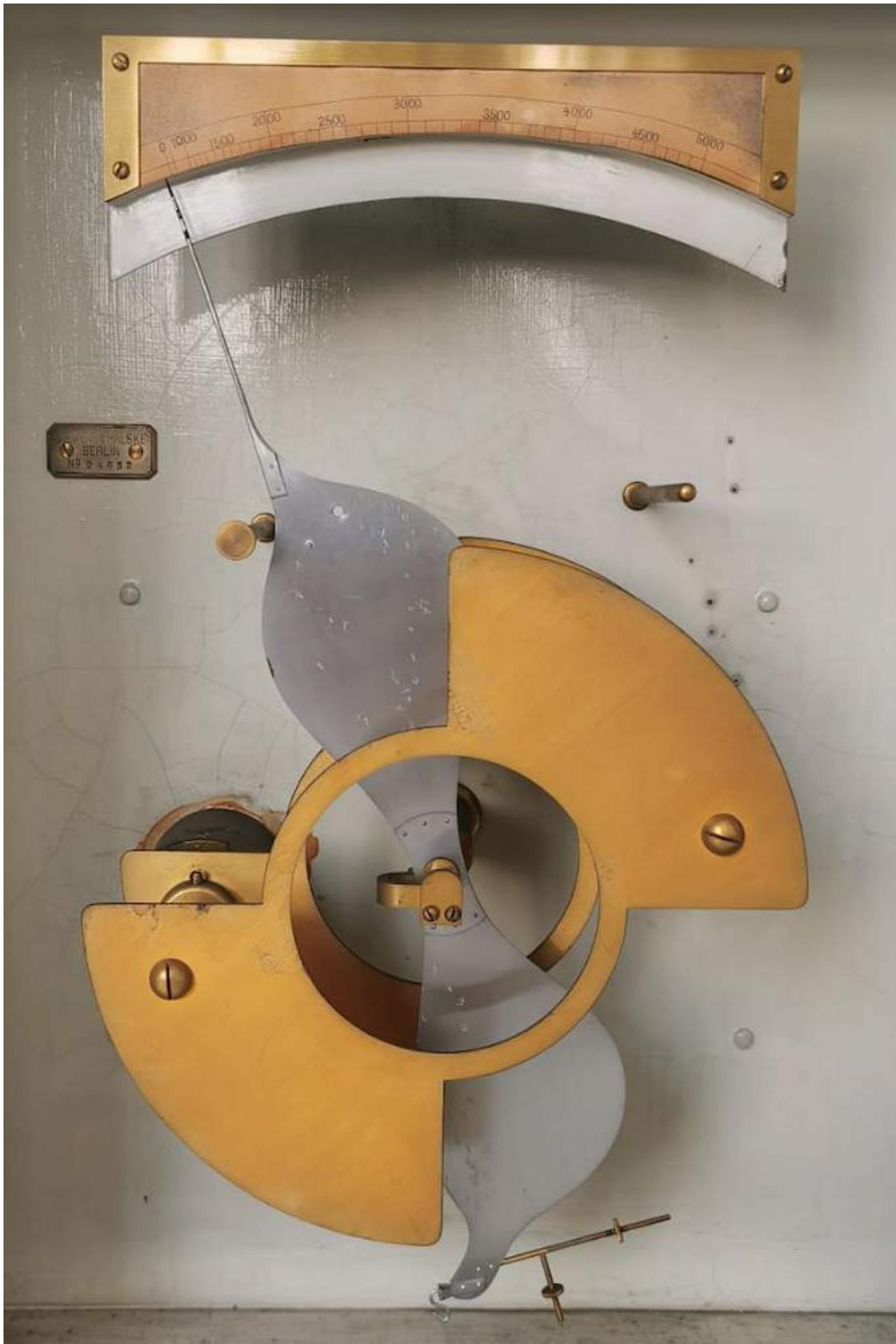
Abbildung 3.2: Nr.24632 - Messvorrichtung des Voltmeters
