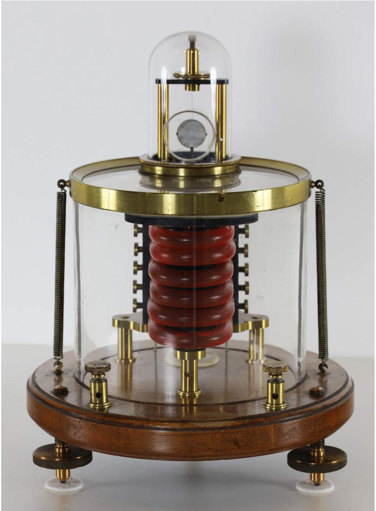
Abbildung 10.1: Spiegelgalvanometer - Nr.1028
