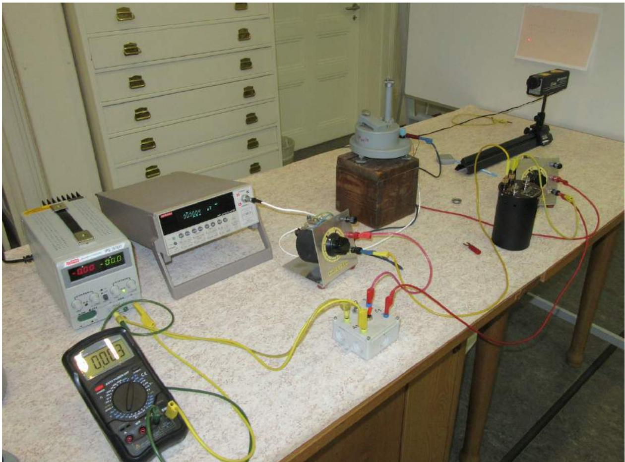
Abbildung 11.3: Zernikegalvanometer HVII/14
