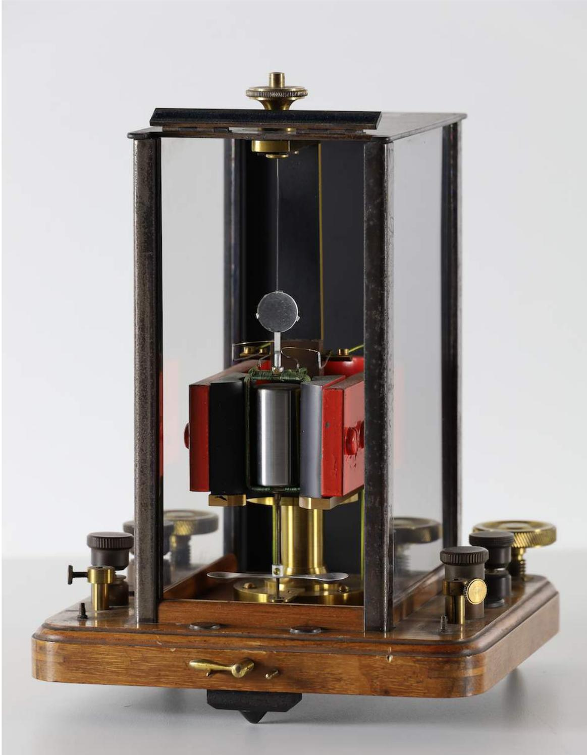
Abbildung 8.1: Spiegelgalvanometer im Glasgehäuse - Nr.187
