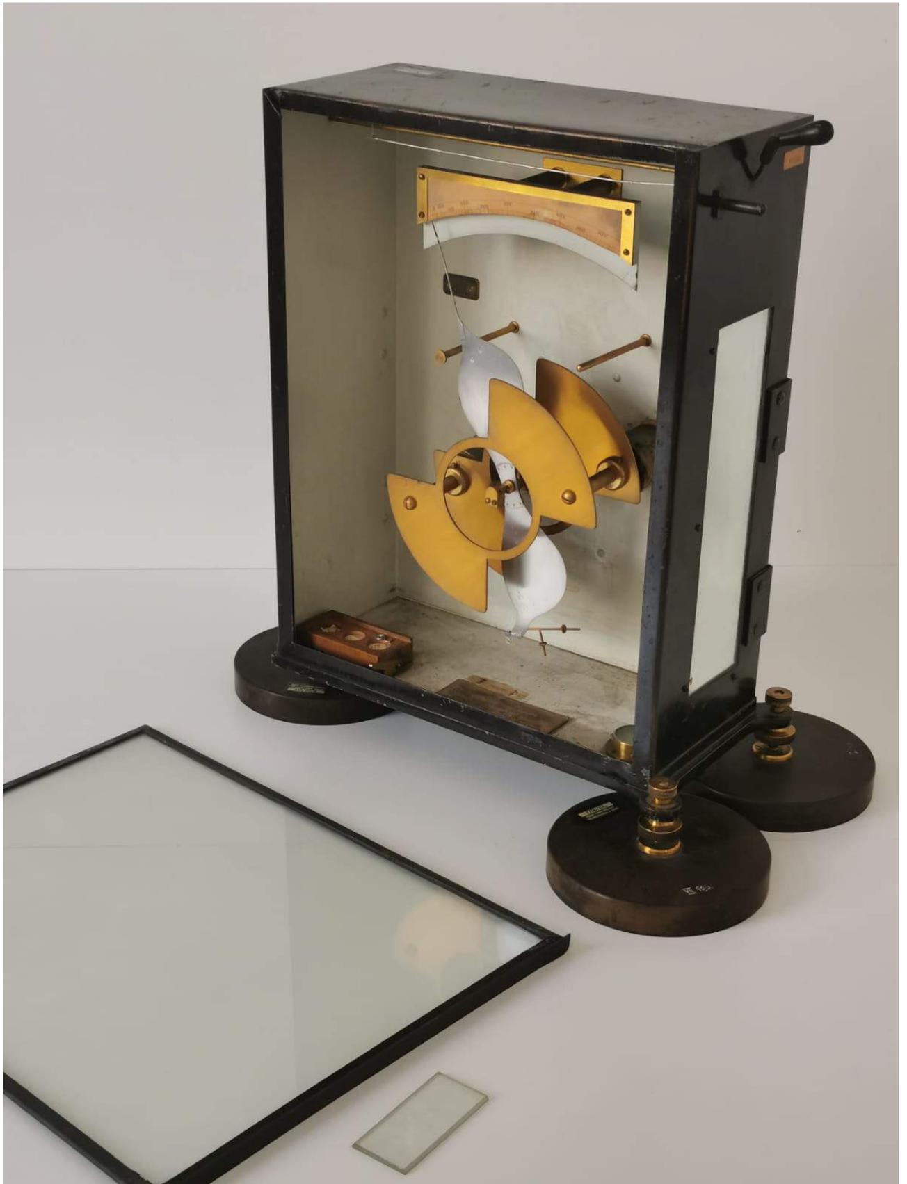
Abbildung 3.1: Elektrostatisches Voltmeter nach Thomson - Nr.24632
