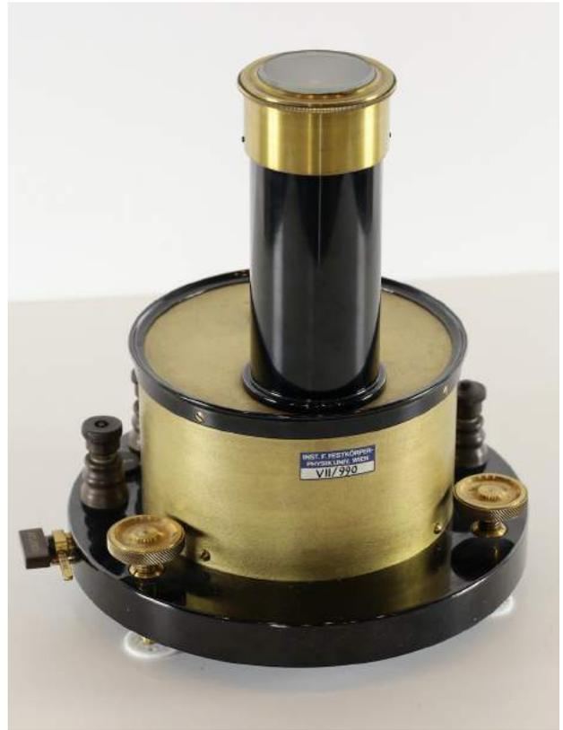
Abbildung 12.1: Doppelspulengalvanometer Nr.865 a) Vorderseite b) Rückseite
