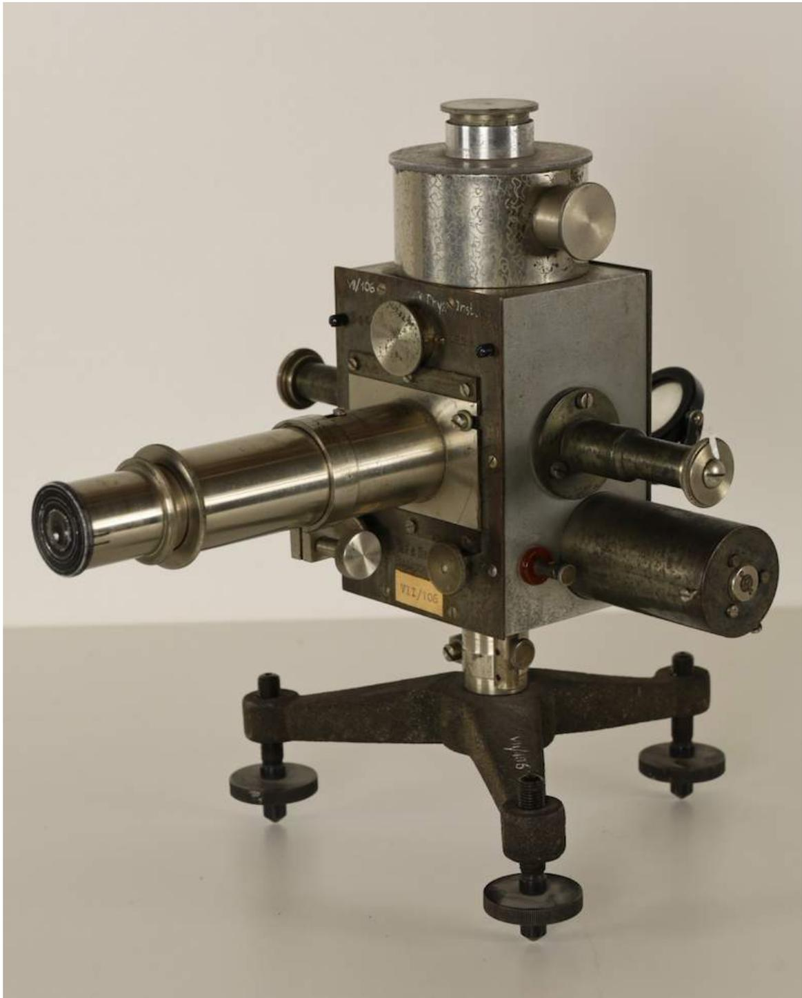
Abbildung 5.1: Einfadenelektrometer Nr.3246
