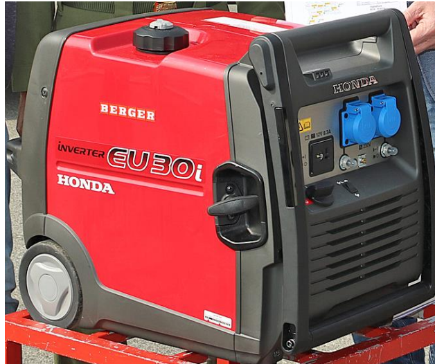
Abbildung 36: Notstromaggregat für Basisstationen Burgenland (Quelle: Bgl. Landesmedienservice, 2019)
