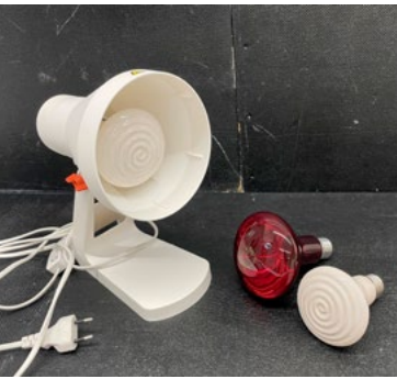
Abb. 1: Wärmelampe, bei der der Leuchtkörper durch eine Keramiklampe ersetzt wurde.
