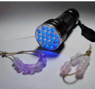
Abb. 2: UV-Taschenlampe und UV-Perlen, die sich durch UV-Strahlung verfärben.
