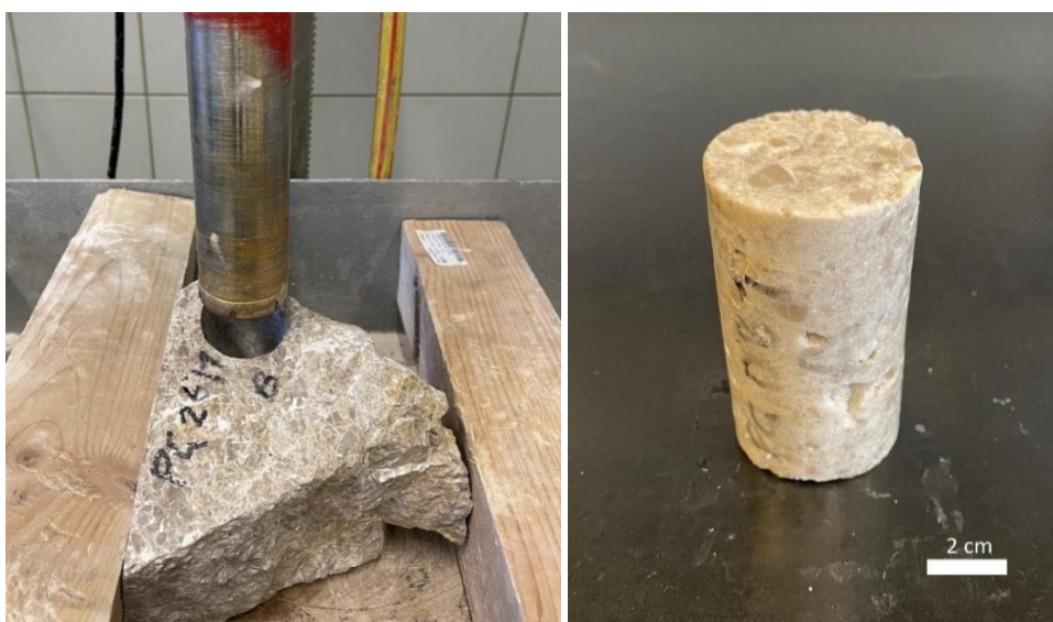
Abbildung 27: Plug-Bohrer (links) und fertig zugeschnittener Plug (rechts).
