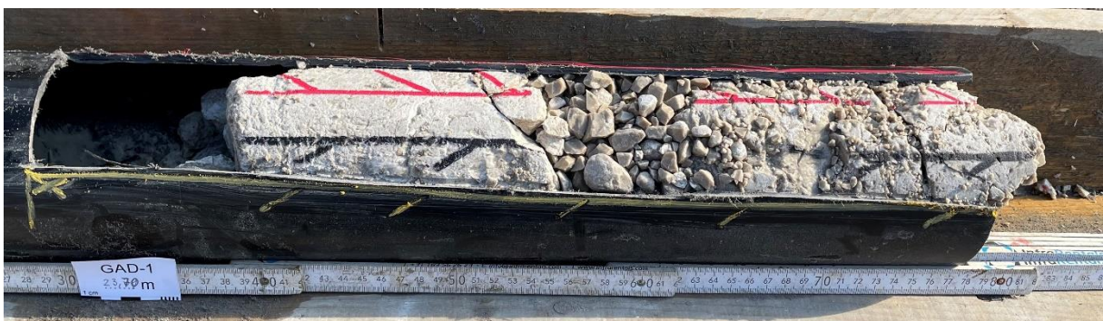
Abbildung 25: Nach dem Ausschneiden eines Sichtfensters im schwarzen Liner werden am Kern und am Liner selbst eine rote (rechts) und eine schwarze/gelbe (links) Markierungslinie am Kern angebracht, damit der Kern später richtig orientiert werden kann (oben/unten). Zusätzlich werden die Teufenangaben angeschrieben.
