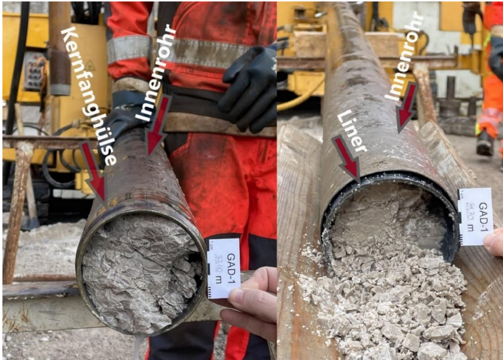
Abbildung 21: Innenrohr mit Kernfanghülse (links) und Innenrohr mit Liner nach Entfernen der Kernfanghülse (rechts).
