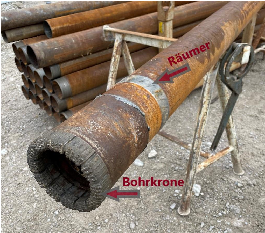
Abbildung 19: Außenrohr mit diamantbesetzter Bohrkrone & Räumer.
