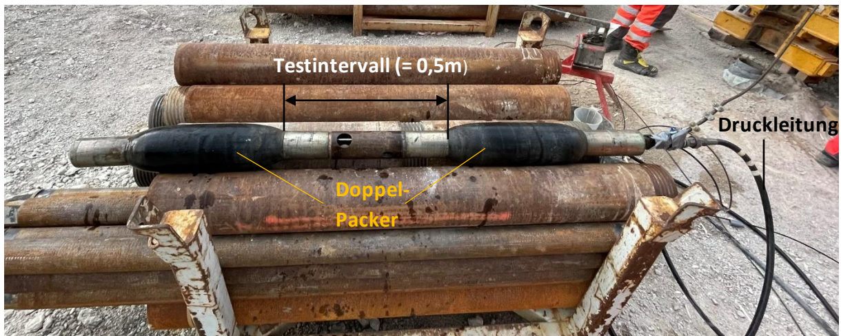
Abbildung 38: Der bei Bohrung GAD-1 verwendete Doppelpacker.
