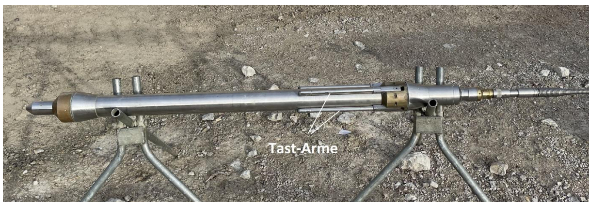
Abbildung 31: Verwendete Kalibersonde bei Bohrung GAD-1.
