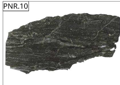
Abbildung 8.2.G: beinhaltet ein ähnliches Gefüge wie PNR.7, führt jedoch einen höheren Anteil an Karbonatfragmenten. Die Matrix ist aufgrund erhöhter Oxidation deutlich roter und führt im Vergleich keine erkennbaren Fossilien (mehr).
