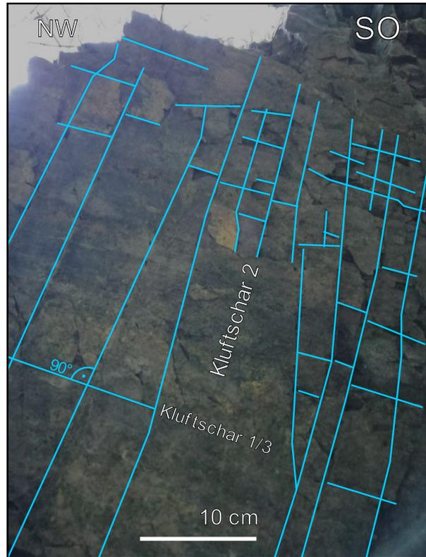
Abbildung 7.1.A2: Skizzierung des Verlaufs der Kluftscharen 1 und 2, mit gleicher Ansicht wie in 7.1.A1 und eingezeichneten  $\sim 90^\circ$  Winkel, der sich auch aus der Berechnung von Stereonet, zwischen den beiden Flächen ergibt (N47.08306846, O11.45360951).
