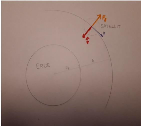
Auf den Satelliten wirken zwei Kräfte ein, nämlich die Gravitations- und Zentrifugalkraft.
