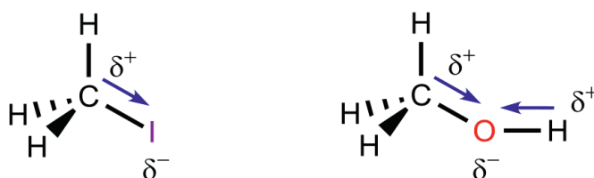
Abbildung 2.23. Negativer induktiver Effekt ( -I -Effekt) am Beispiel eines Halogenalkans und eines Alkohols.
