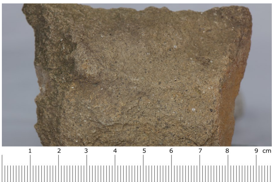
Abbildung 54: Verwitterungsoberfläche eines Flysch-Sandstein aus einem marinen Ablagerungsmilieu, Klosterneuburg – Niederösterreich (KORHERR 2024)
