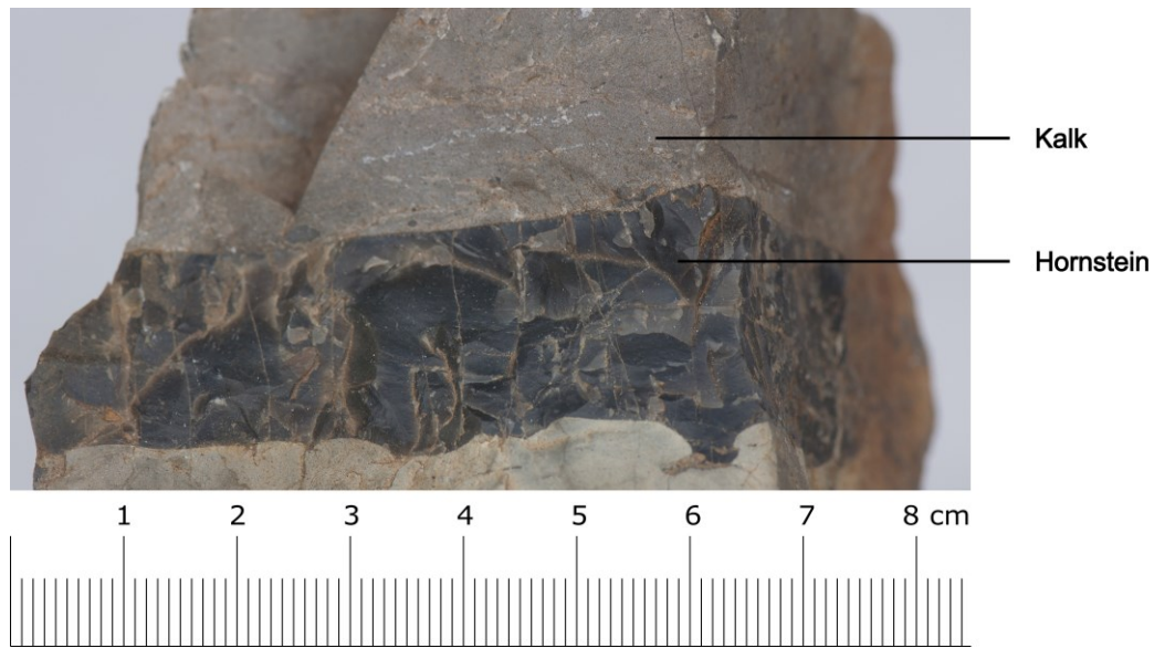
Abbildung 49: Hornsteinlage mit scharfkantigem, muscheligem Bruch in Kalk, Wien (KORHERR 2024)
