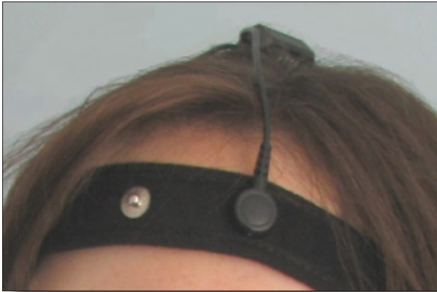
Abb. 4: Hautleitfähigkeitssensor, Anbringung mit Stirnband
